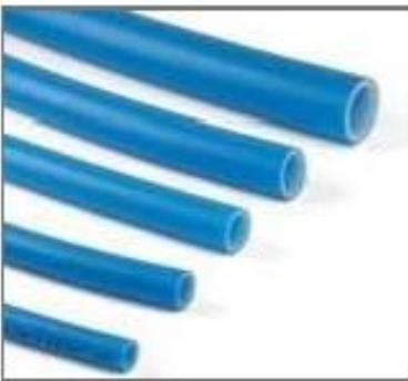
Le haut degré de réticulation du processus PEXa de REHAU permet d'obtenir une conduite durable et flexible avec des propriétés de température et de pression supérieures, une meilleure résistance hydrostatique à long terme ainsi qu'une résistance améliorée aux fissures de contrainte causées par l'environnement.
