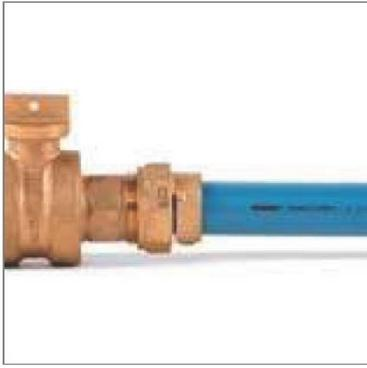
5. Poussez l'écrou et la bague sur le corps du raccord à compression et engagez les filets. Selon les directives du fabricant du raccord ou de la vanne, serrez l'écrou, tel que requis.
