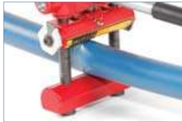
Réarrondissement de la conduite
