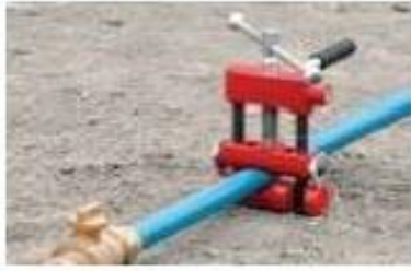
Conduite dans l'outil d'obturation par écrasement
