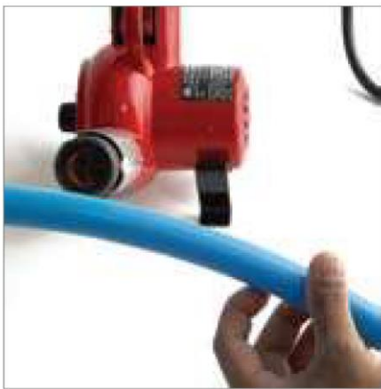
Réparer les plis à l'air chaud
